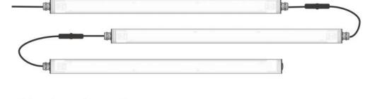
La longueur de chainage maximum, câble inclus, ne doit pas dépasser 100 m.
