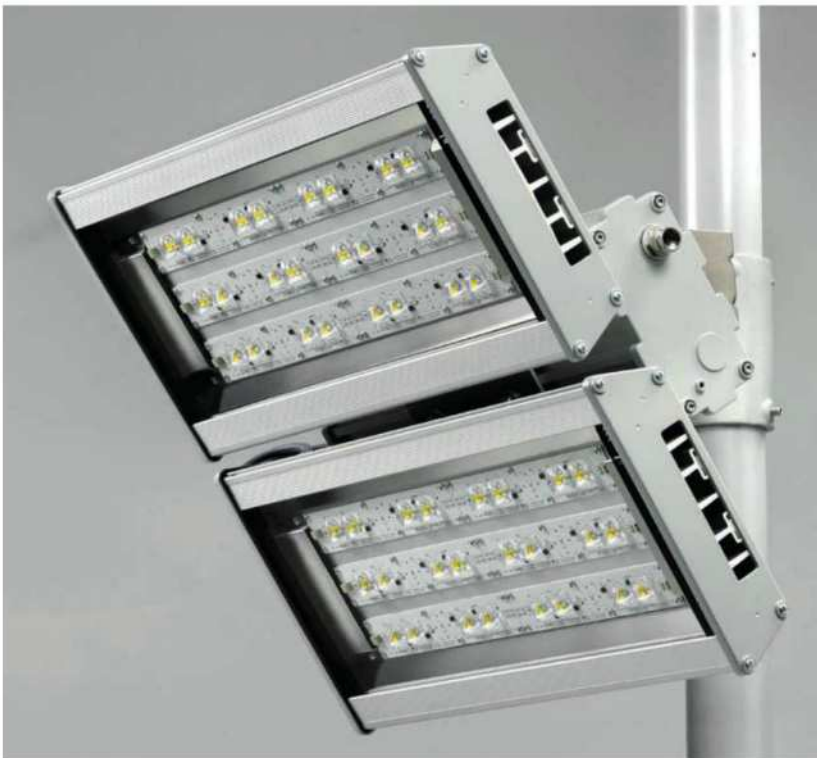
Excellent management thermique par effet BERNOULLI , les véhicules qui passent dans le tunnel poussent l'air comme un piston, l'air passe par le luminaire et accélère la dissipation
