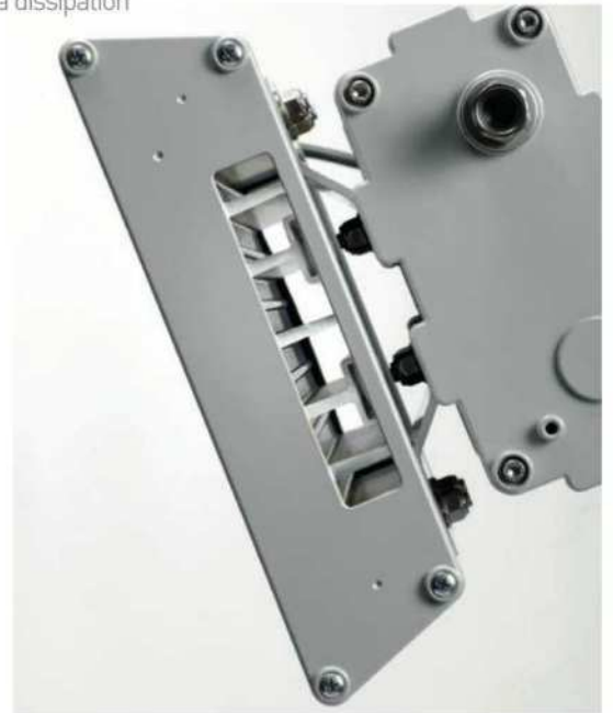
Excellent management thermique par effet BERNOULLI , les véhicules qui passent dans le tunnel poussent l'air comme un piston, l'air passe par le luminaire et accélère la dissipation
